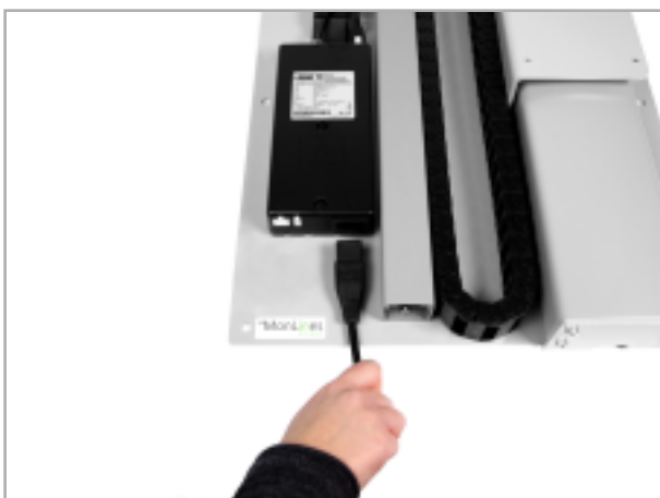
Abb. 3: Verkabeln der Steuereinheit
